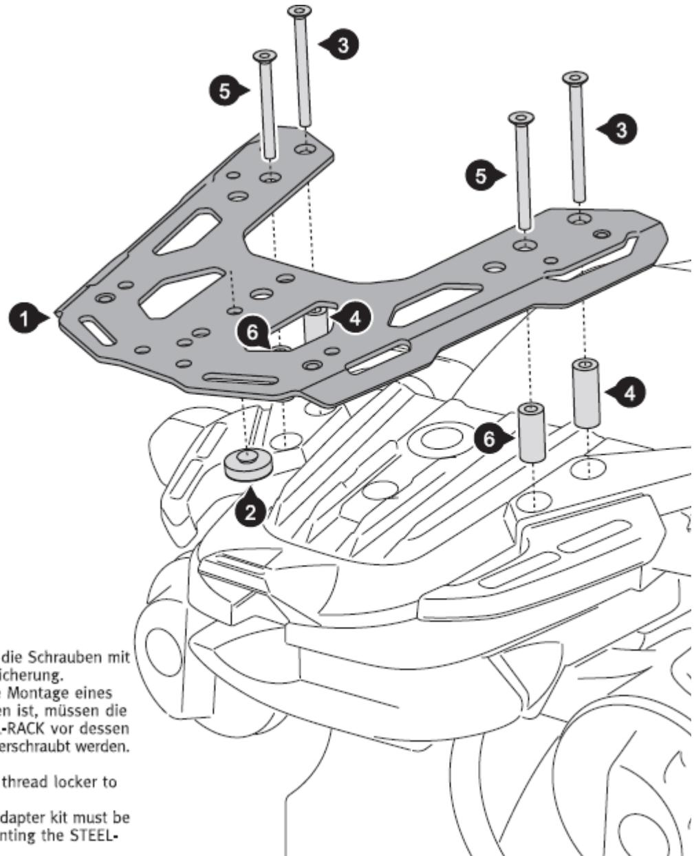
die Schrauben mit Sicherung.
